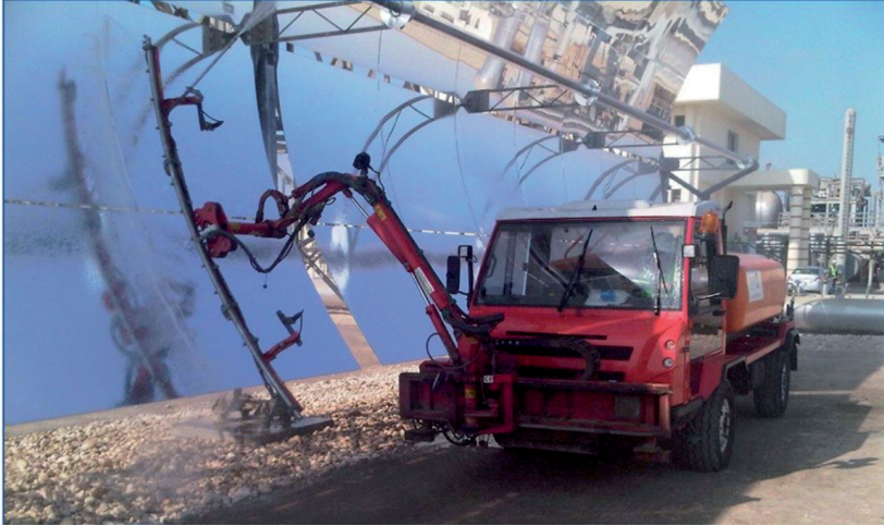
Abb. 3.1.2.2: Reinigung der Parabolrinnen des solarthermischen Kraftwerks Kuraymat, Ägypten | Quelle: Gerhard Hofmann, Agentur Zukunft
