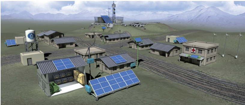
Abb. 3.2.1.3.1: Beispiel einer Minigrid-Anlage mit dezentraler PV-Stromerzeugung, Windkraftanlagen, Batterien, einem Dieselgenerator und einem kleinen Verteilernetz. Zusätzlich ist hier ein großer Wasserspeicher zu sehen. Die Pumpe für den Wasserspeicher dient als Beispiel für eine zeitlich verlagerbare Last, die Teil eines integrierten Steuersystems sein kann, das auch das Nachfragemanagement (Demand-Side-Management) umfasst. | Quelle: http://www.ennera.com/en/detail-solution/minigrids
